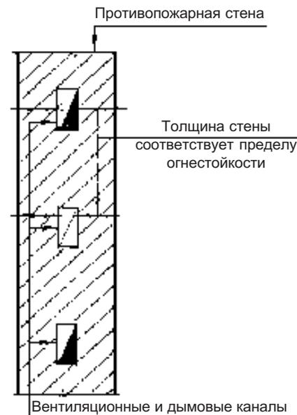
Рис. 3.7. Размещение вентиляционных и дымовых каналов в противопожарных стенах
