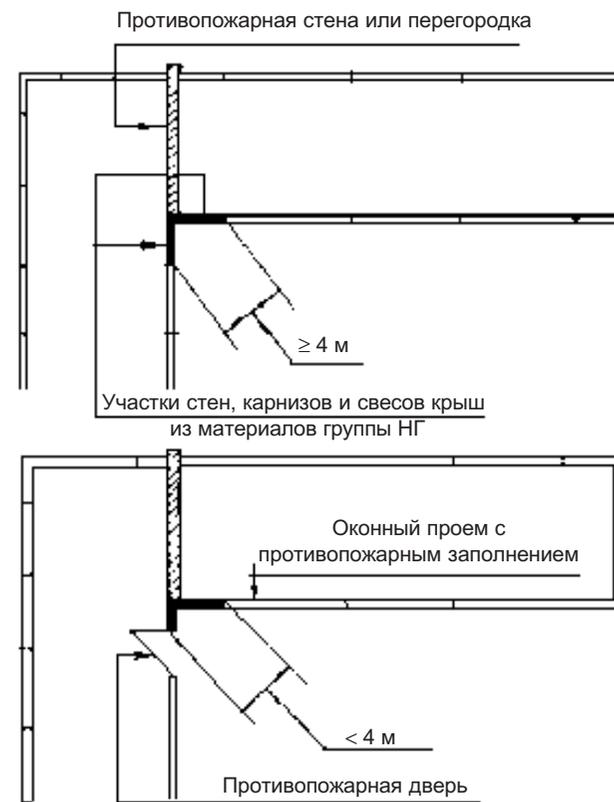
Рис. 3.3. Участок стены в местах примыкания частей зданий под углом, разделенных противопожарными стенами
