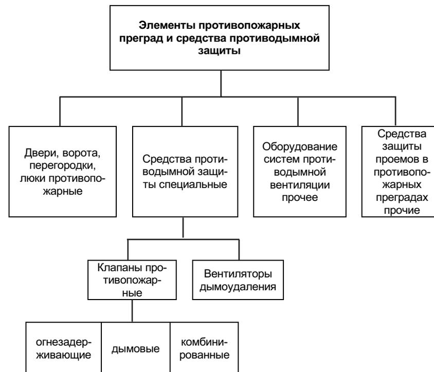
Рис. 2.1. Классификация элементов противопожарных преград и средств противодымной защиты.
