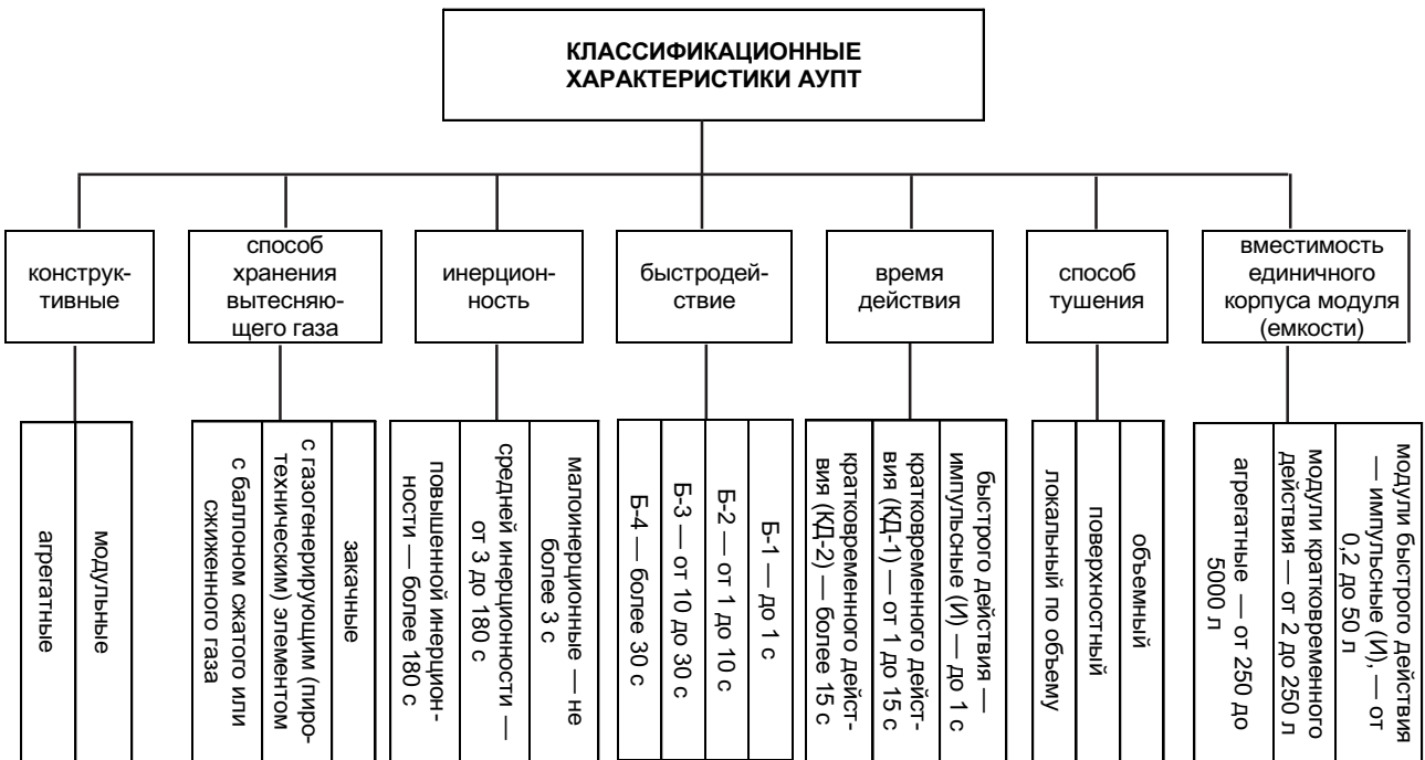
Рис. 2.10. Классификация автоматических установок
