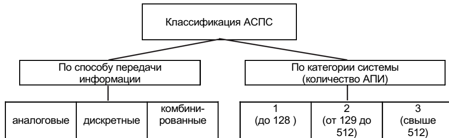
Рис. 2.2. Классификация адресных систем пожарной сигнализации
