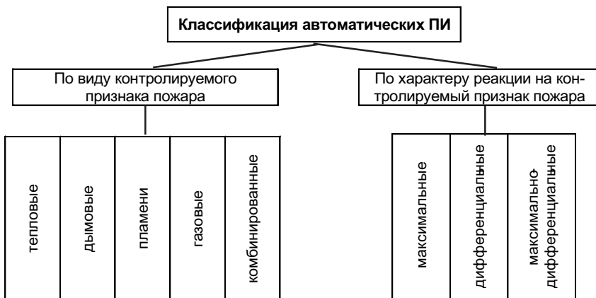
Рис. 2.6. Общая классификация автоматических пожарных извещателей.
