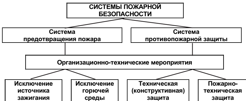
Рис. 1.2. Структурная схема систем пожарной безопасности
