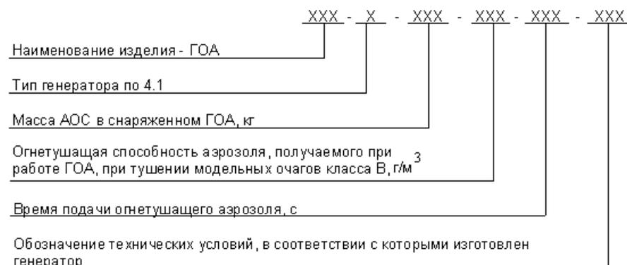
Пример условного обозначения генератора, применяемого в стационарных системах объемного аэрозольного пожаротушения, второго типа (образующего при работе огнетушащий аэрозоль с температурой от 130 до 500 °С), с массой заряда АОС в снаряженном генераторе 2,0 кг, огнетушащей способностью аэрозоля, получаемого при работе ГОА, при тушении модельных очагов класса В равной 47 г/м<sup>3</sup>, временем подачи огнетушащего аэрозоля 30 с, по ТУ 4854-003-07509209.
