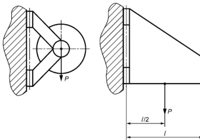
Рисунок 1 - Схема приложения нагрузки  $P$  к рукавной кассете
