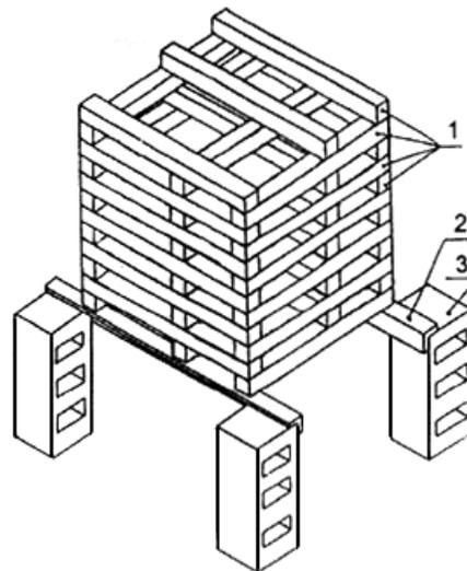
1 - деревянные бруски, 2 - стальной уголок, 3 - бетонный (металлический) блок
