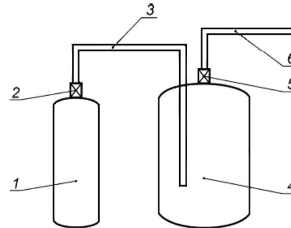
1 - баллон для хранения газа; 2 - ЗПУ; 3 - трубопровод подачи газа; 4 - емкость для хранения порошка; 5 - мембранный узел; 6 - насадок
