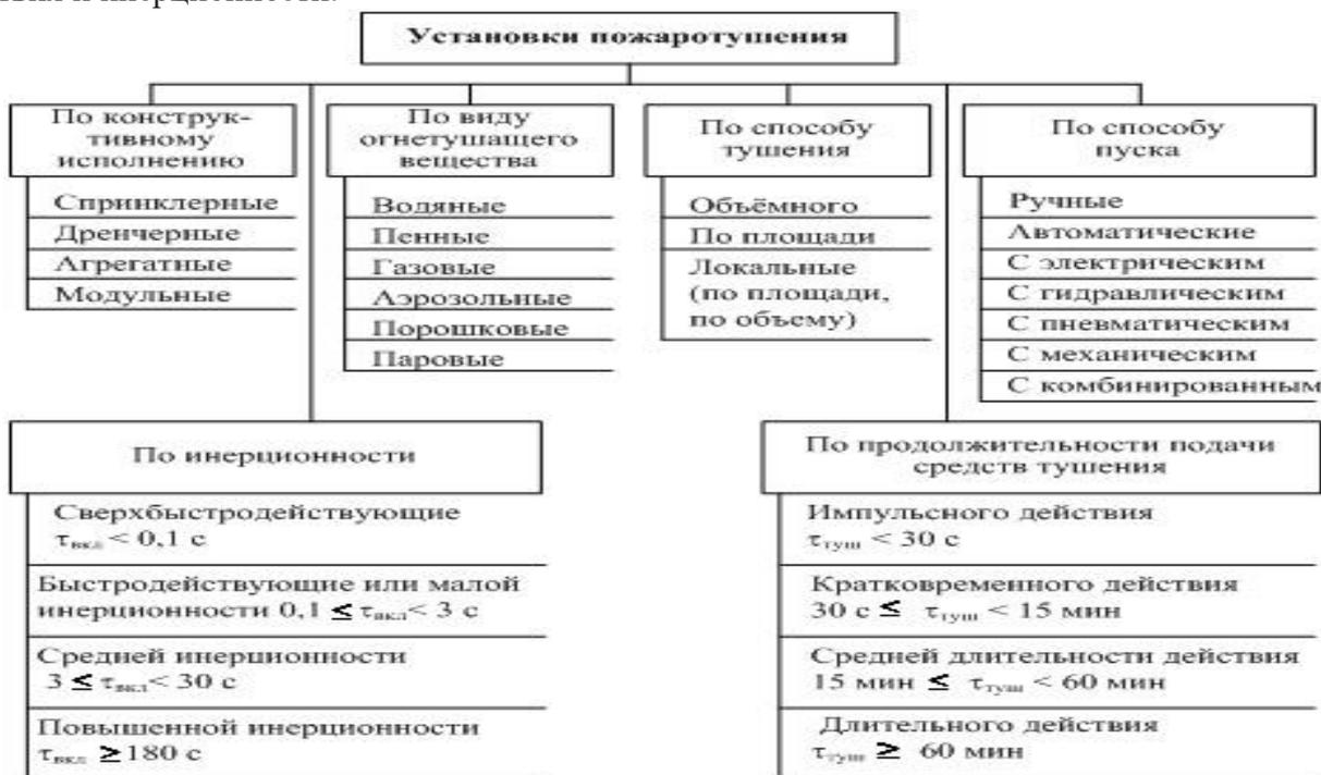
Таблица 4. Обобщенная классификация установок пожаротушения
