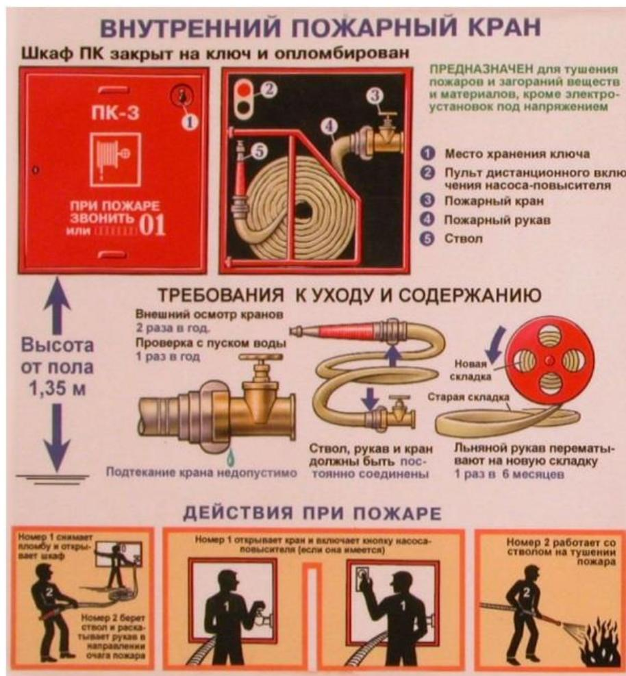
Рисунок 4. Требования к пожарному крану
