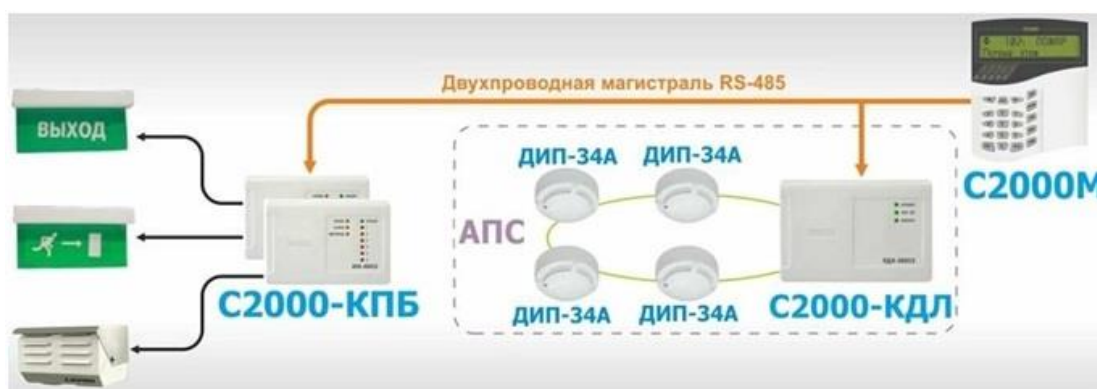
Рис. 5 Схема СОУЭ 2 типа
