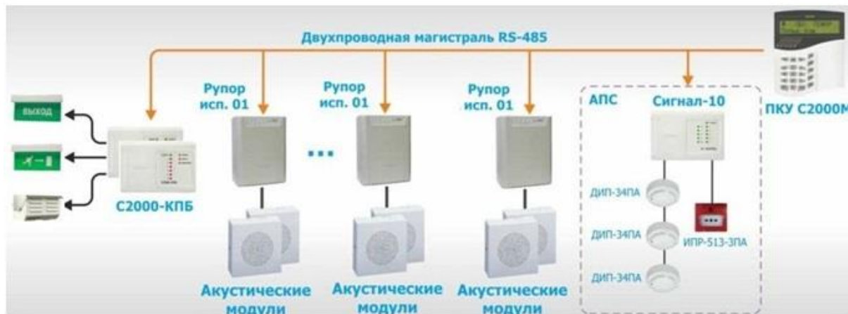
Рис. 6 Схема СОУЭ 3 типа с несколькими зонами оповещения
