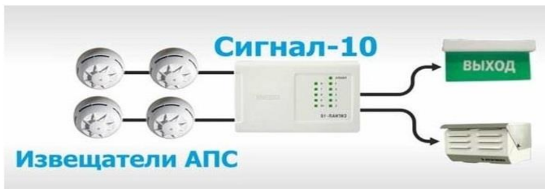
Рис. 4 Схема СОУЭ 1 типа
